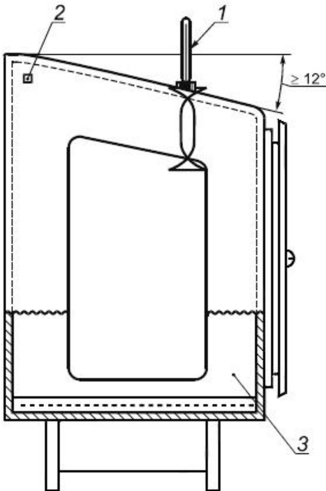
1 - термометр; 2 - клапан сброса давления; 3 - поддон, наполненный водой
